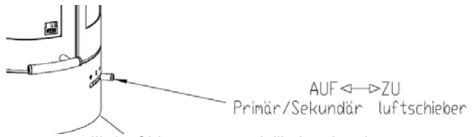
III. 3 : Chiusura presa dell'aria primaria
